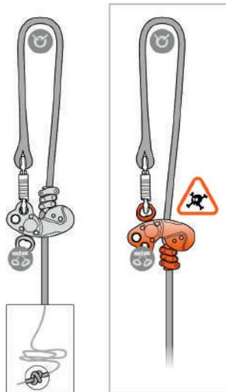
6d. Setup on a single rope / Installation sur corde en simple
